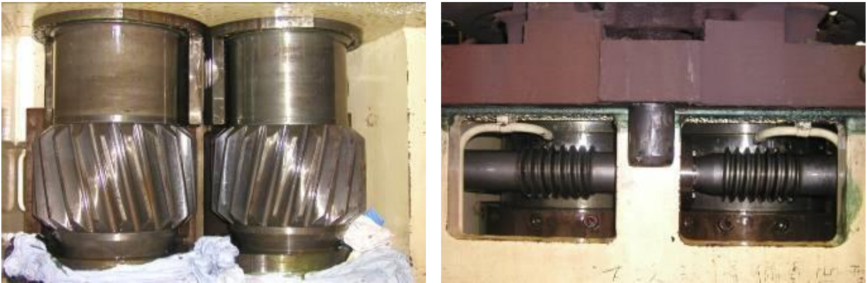
圖(二) 高速線材軋機設備齒輪箱
